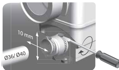
Fig. 35 Højde- og sidejustering mulig ved brug af Ø36/40 tilløbsrør
